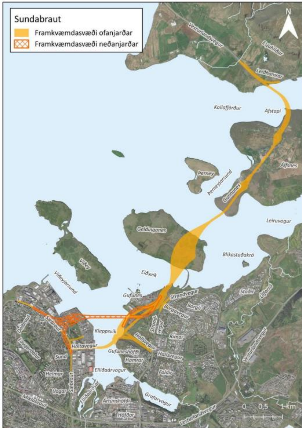
Mynd 1. Fyrirhuguð lega Sundabrautar samkvæmt tveimur aðalvalkostum Vegagerðarinnar þar sem Kleppsvík er annað hvort þveruð með brú (gul; Sundabrá) eða jarðgöngum (appelsínugul; Sundagöng) (mynd úr umhverfismatsskýrslu).
