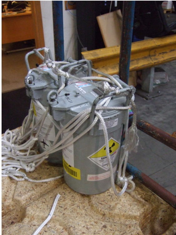
Mynd 2: Dæmi um geislalindir á Keflavíkflugvelli, sem komu með fraktflugi frá Evrópu og bíða þess að vera fluttar áfram til Bandaríkjanna. Þær eru í mjög tryggum hylkjum og um flutninginginn gilda strangar reglur.
