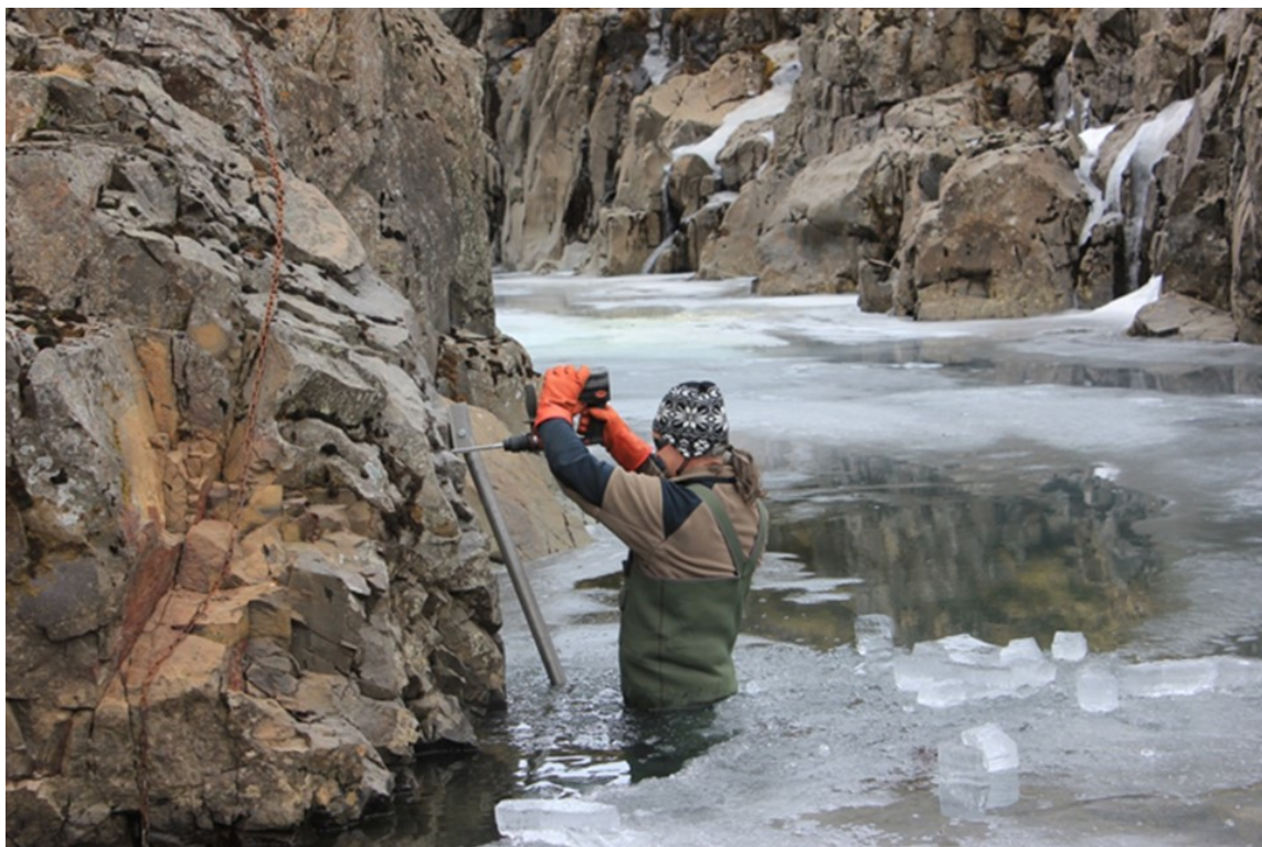
2. mynd. Unnið að uppsetningu osmótíska safnarans í Fellsá við Sturluflöt í Fljótsdal. Safnarannum var komið fyrir undir göngubrúnni þar sem dýpi er nægilega mikið til þess að safnarinn fari ekki á þurr (mynd : Iwona Monika Galeczka).
