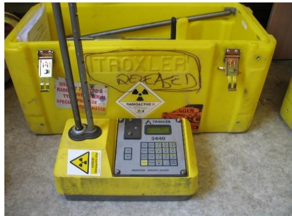
Mynd 8. Færanlegt raka- og þéttnimælitæki og flutningskassi. Í tækjum af þessari gerð eru yfirleitt tvær geislalindir (GR).
