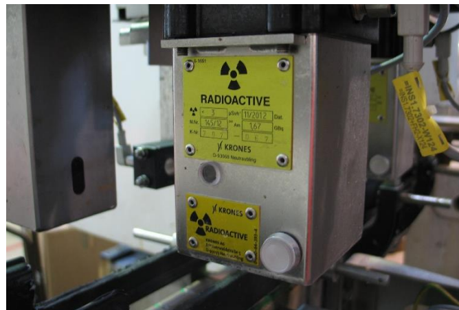
Mynd 6. Geislalind í framleiðslulínu í gosdrykkja verksmiðju. Notuð til að fylgjast með áfyllingarhæð í flöskum og dósum (GR).
