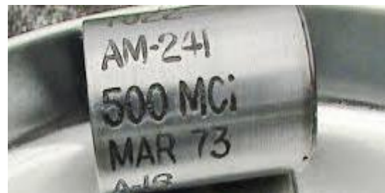
Mynd 4. Lokað geislalind með einkvæmt raðnúmer, kjarntegund, virkni og viðmiðunardagsetningu fyrir virkni (GR).
