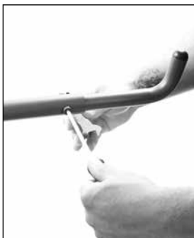
13. Notaðu sexkant og 13 mm skiptilykil til að fjarlægja róna og skinnuna. Settu í þá stöðu sem óskað er eftir. Hertu vel með sexkanti og 13 mm skiptilykli. Settu svarta hlífðarhettu yfir róna.
