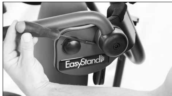
14. Notaðu sexkant til að stilla hæð stuðningsarmsins til að stilla af bakkann.
