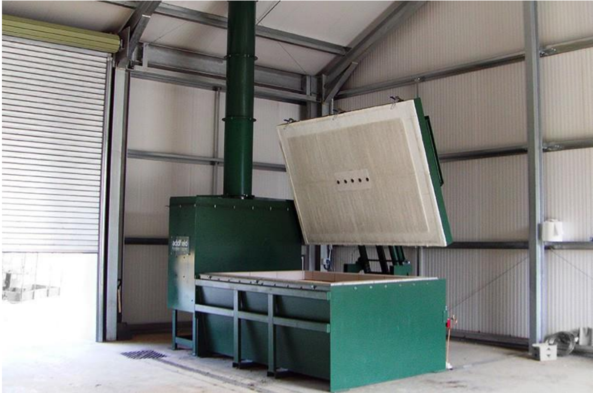
MYND 7 Brennsluofn af gerðinni TB-AB sem verður notaður við brennslu á úrgangi í áhættuflokki 1. Mynd fengin frá Addfield.
