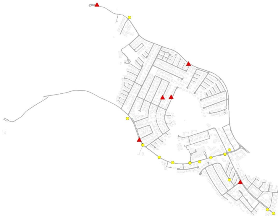
Mynd 2.2 Slys á Seltjarnarnesi árin 2012-2016. Gulir hringir eru slys með litlum meiðslum og rauðir þríhyrningar slys með alvarlegum meiðslum.
