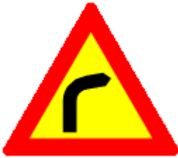
A01.11 Hættuleg beygja til hægri.
