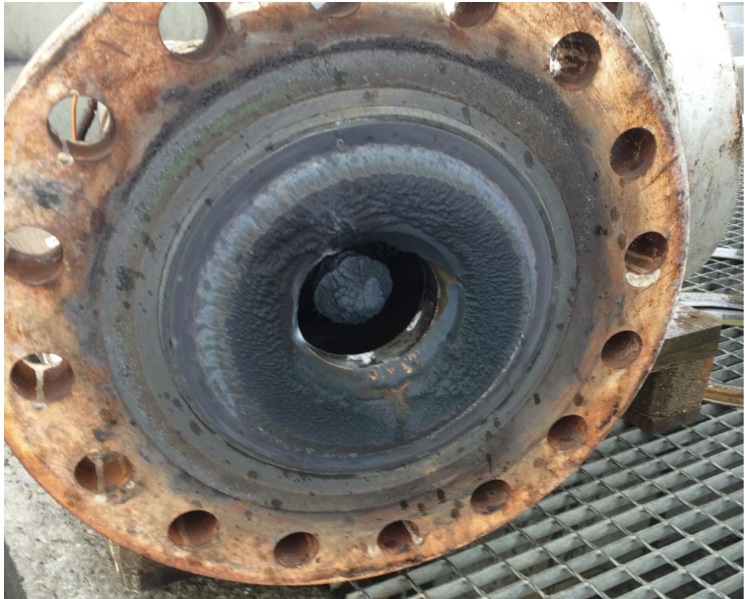
Mynd 4.1 Útfellingar mynda svarta skán í lögn aftan við holutoppsloka.
