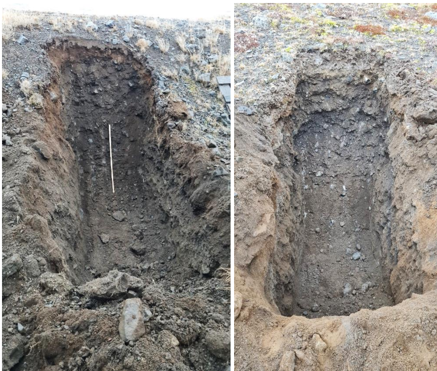
Mynd 3.6 Tvær könnunargryfjur sem voru gerðar í jaðri núverandi efnistökusvæðis sunnan Bollastaða.
