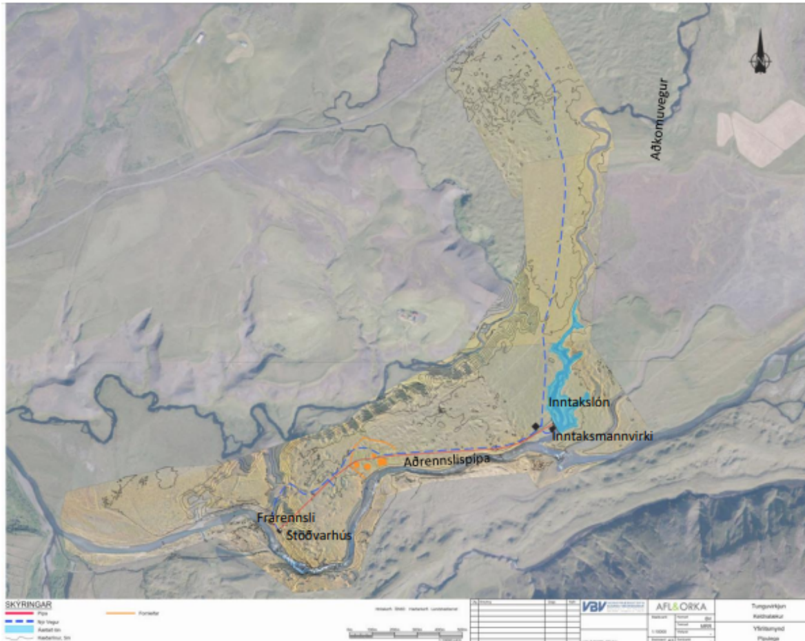
Mynd 1: Staðsetning aðkomuvegar (blá stríkalína), inntaksmannvirkis, inntakslóns, aðrennslispípu (rauð lína), stöðvarhúss, frænnslisskurðar og skráðra fornleifa (appelsínugult) (mynd fengin úr greinargerð framkvæmdaraðila)
