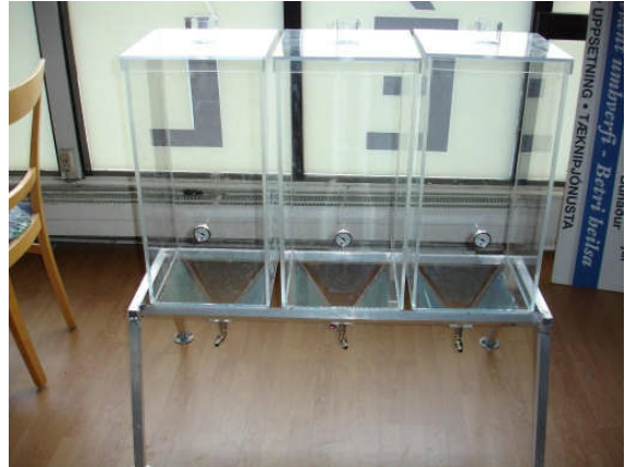
Gegnsæir tankar þar sem sóða og metanóli er blandað saman. Einnig má nota þessa tanka til vatnsvöskunar í litlu mæli
