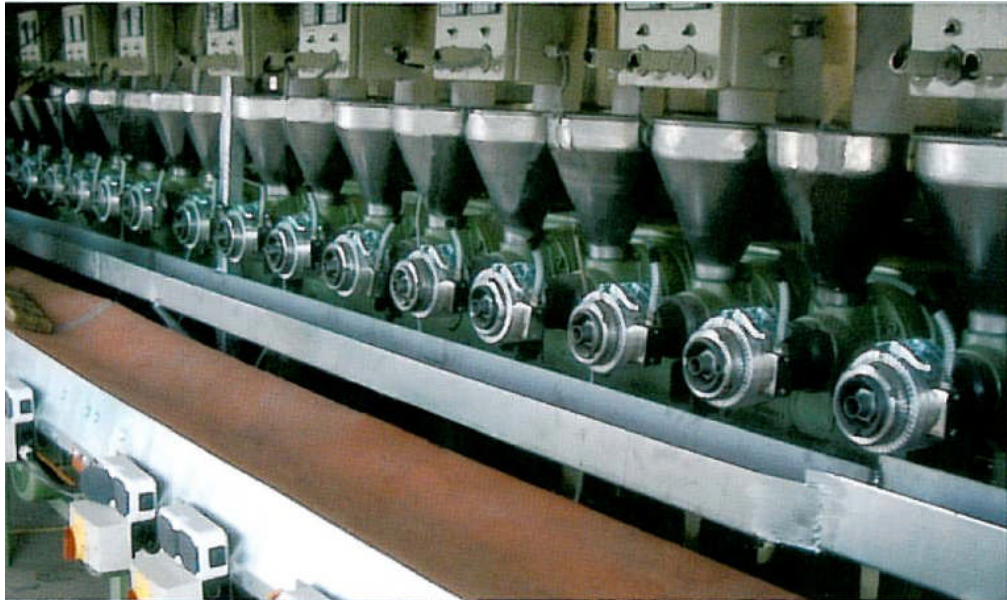
Pressukerfi með rennu fyrir olíuna og færiband fyrir mjölið
