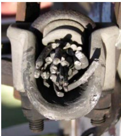
Mynd 52: Valhopp orsakaði þreytubrot í leiðara við upphengi, mynd frá 400 kV línu í Noregi.
