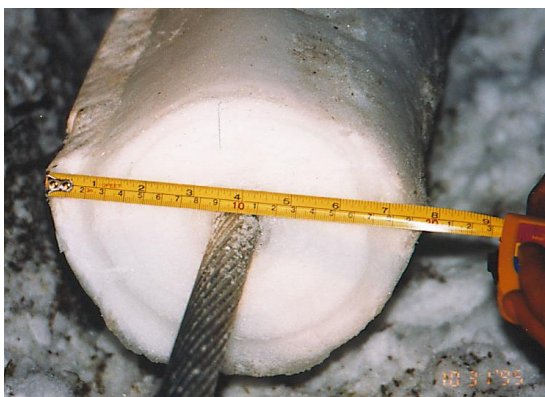
Mynd 10: Slydduísing á leiðara, þvermál 20 cm, um 20 kg/m.
