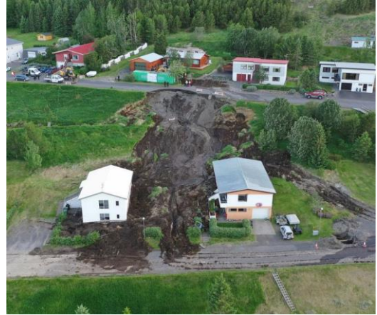
Mynd 28: Skriða í Varmahlíð 28. Júní 2020. Skriðan er talin afleiðing af miklu vatni í jarðvegi á svæðinu en þó ekki bein afleiðing af leysingum (Ljósmynd: Lögreglan á Norðurland Vestra).
