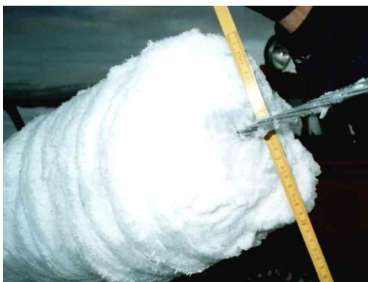
Mynd 11: Skýjaísing á stagvír, þvermál 20 cm, um 16 kg/m.
