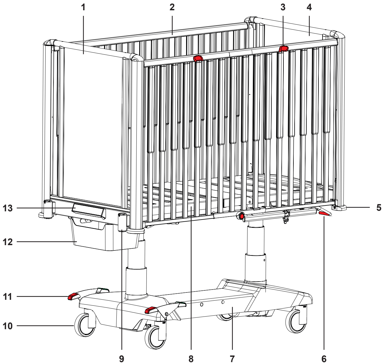
Mynd Yfirlit yfir Tom 2-rúm með útdraganlegum hliðargrindum og föstum höfða- og fótagaflum
