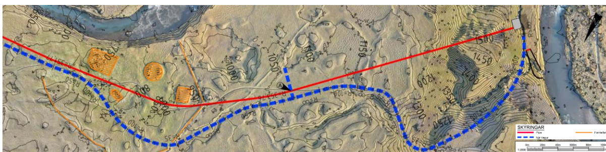
Mynd 3.7 Nýr vegslóði frá inntaksmannvirki meðfram aðrennslispípu að stöðvarhúsi, seinni hluti.
