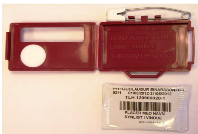
Mynd 1. TLD-mælihylki og TLD-mæliplata
