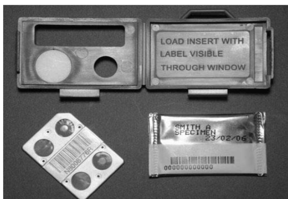
Mynd 2. TLD-geislaálagi (opið efst), TLD-mæliplata (t.v.), innþökkuð og áletruð mæliplata (neðst t.h.)
