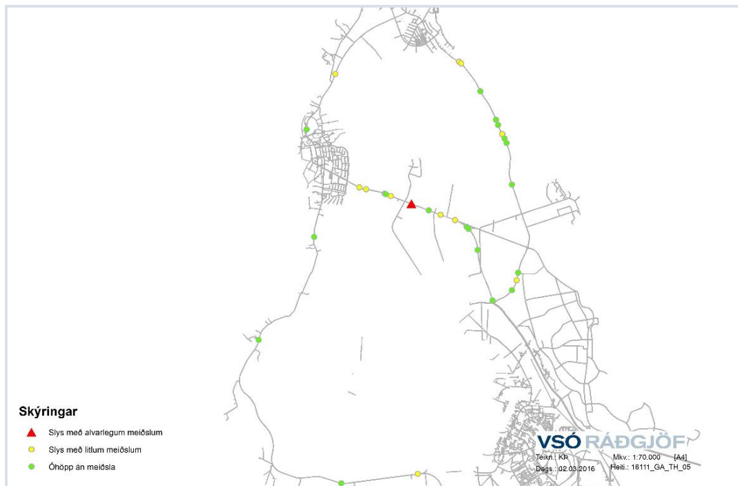
Mynd 2.7 Óhöpp skráð á þjóðvegum í Garði og Sandgerði árin 2011-2015 þar sem ekið er út af.
