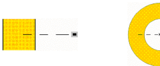
Mynd 3.1.2. Geislavirkt efni jafndreift í sýni (vinstri). Hjúpur sem umlykur geislanema (hægri).
