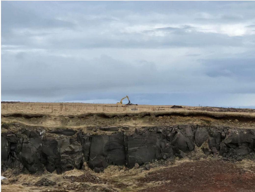
Mynd 15. Lag með jökulruðningi/ mól, liggur ofan á berginu og þar fyrir ofan mold með gróðri.
