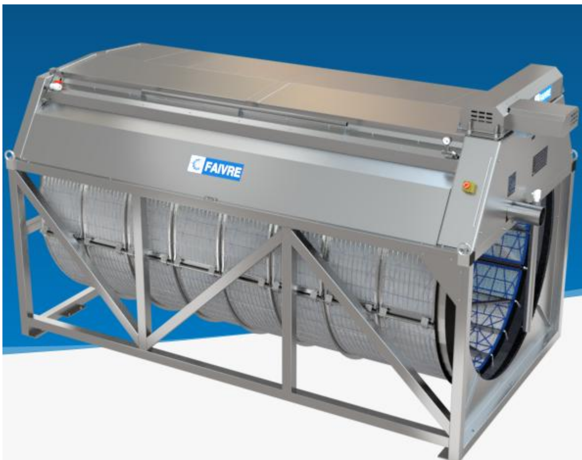
Mynd 45. Tromla af þessu tagi er gefin upp til að hreinsa 900 l/sek af vatni/sjó og ná kornum niður í (60 \mu ). Þrír slíkir myndu duga fyrir hvert og eitt af sex áætluðum vatnskerfum, samtals 18 slíkar síur fyrir áfanga 3 og þrjár fyrir áfanga 2.
