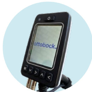
EU414 Schnittstelle mit optischer Rückmeldung für Sondereingaben
