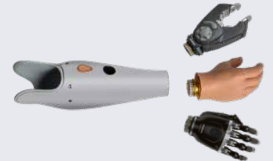
筋電義手は、脳の指令により筋肉が収縮する際に発生する微弱な電流である筋電（表面筋電位）を、モーターを動かすスイッチとして利用する義手システムです。身体の上や前方など作業空間を選ばない特徴により、様々な両手動作が可能になります。
