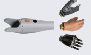
筋電義手は、脳の指令により筋肉が収縮する際に発生する微弱な電流である筋電 (表面筋電位) を、モーターを動かすスイッチとして利用する 義手システです。 身体の上や前方など作業空間を選ばない特徴により、様々な両手動作が可能になります。
