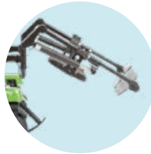
EB004 Beinstütze elektrisch hochschwenkbar, zusammen steuerbar
