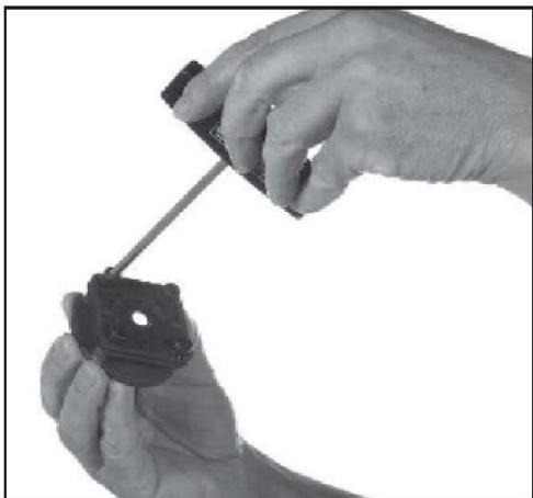
1-2. 断端の長軸にピンの位置が来るよう、陽性モデルにダミーとネジ(503S3)で固定する
