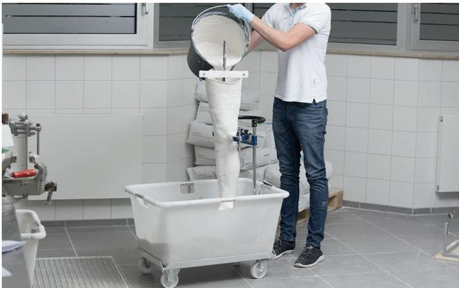
装具用アライメント治具(743A6)上で陰性モデルに石膏泥を流し込みます。
