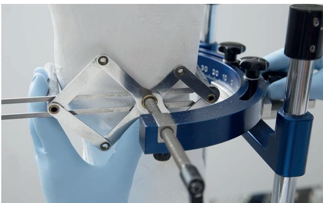
膝関節軸用ゲージ(743A8)を使用して、膝関節のA-P位置に装具用アライメント治具(743A6)の膝関節軸を設定します。
