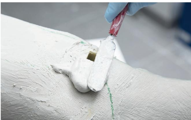
装具の継手と陽性モデルの間に隙間がある場合：
