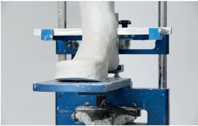
陽性モデルを装具用アライメント治具(743A6)に設置します。
