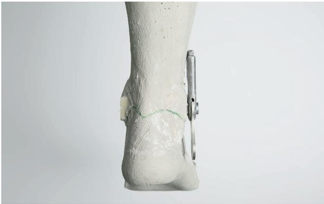
アダプタースリーブ(743Y48)の最適な長さは、装具の継手間の幅になります。装具の継手は、アダプタースリーブに平らに設置し、石膏に触れず、地面に対して垂直に取り付けられるようにする必要があります。
