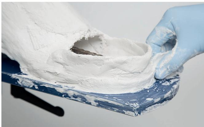
つま先のピッチを石膏シーネで裏打ちします。これにより、石膏泥を流した時につま先部分が下がるのを防ぎます。
