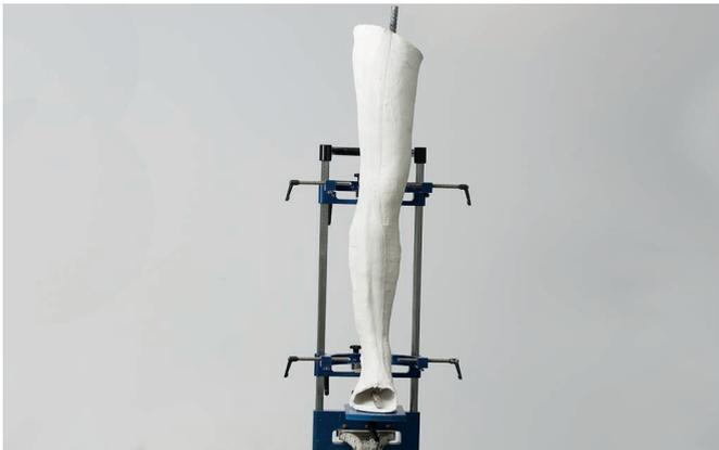
陰性モデルにパイプを入れ、陰性モデルの切り開いた部分を閉じます。
