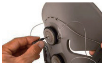
⑥ボア用ドライバーでネジを右に回してダイヤルを取り付ける。
