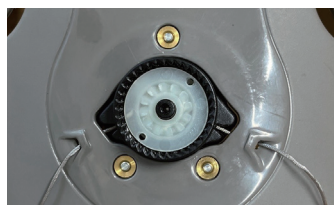
⑤両側のケーブルを引っ張りながらリールを本体に取り付ける。リールの歯車を外側にする。
