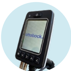
EU414 Schnittstelle mit optischer Rückmeldung für Sondereingaben
