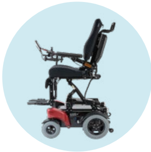
EC041 Sitzhöhenverstellung mit Kantelung
