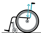
RH= cm Hauteur du dossier Bord supérieur du tube d'assise – bord supérieur de la toile de dossier
