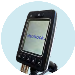
EU414 Schnittstelle mit optischer Rückmeldung für Sondereingaben
