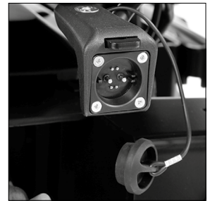
Externe Magnetladebuchse, zu Ladegerät 12 A (EU042)
