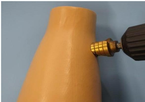
外ソケットにロックアダプターの解除ボタンを操作する用の15mm穴をあけます。
