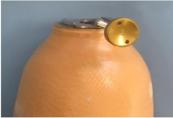
内ソケットのラミネーションリングに、ロックタイトを塗布しロックアダプターを取付けます。
