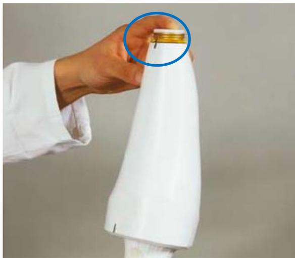
③14A108 ラミネーションリング(プロテクター付)のネジ部分等に樹脂が入り込まないように離型剤を塗布します。
