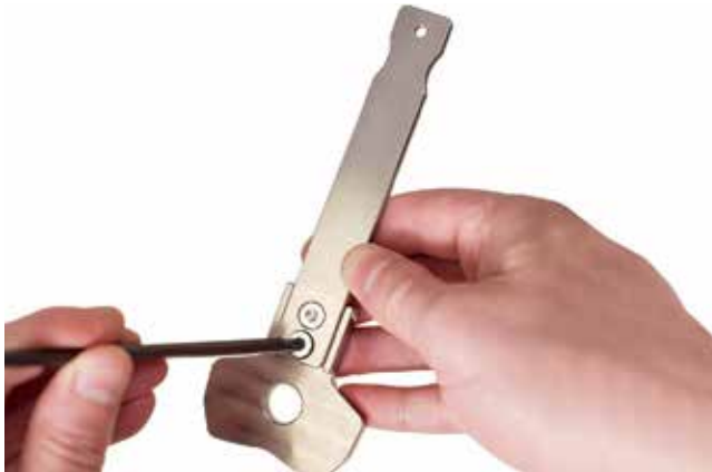
①金属ダミーにラミネーションバーを皿頭ネジでとりつける。
