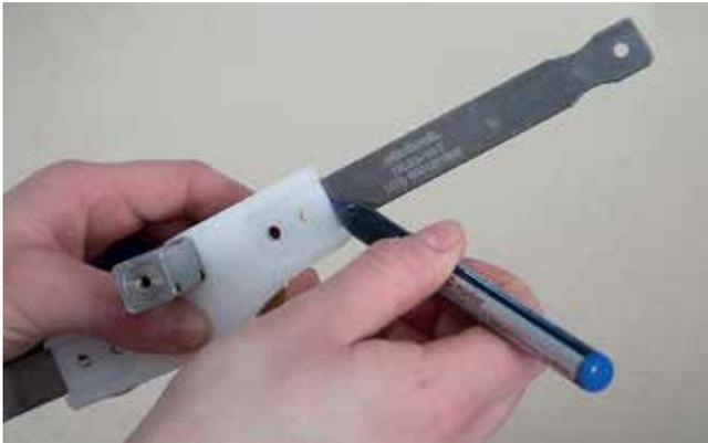
①ラミネーションバーの継手との接合部は曲げてしまうと入らなくなるので、曲げないように注意する。
