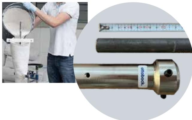
⑥石膏泥を流し混む。パイプを忘れずに入れるようにする。硬化したら陰性モデルをはがす。
