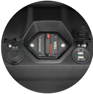
ET004 Anschluss für externe Stromversorgung, rechts USB-Anschluss
