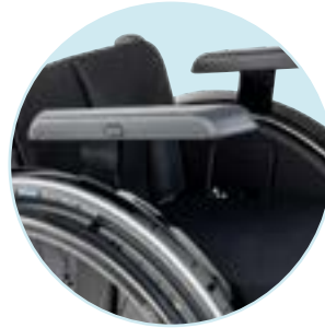
ME17 Kleiderschutz mit integrierter Armauflage, tiefenverstellbar
