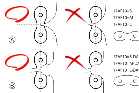
カットラインは、使用する継手によって異なります。ストレートタイプでは、図 A のように、継手前面側を V 字のように切り取りませす。背屈補助付きタイプでは、図 B のように、継手前面側を U 字のように切り取りませす。
