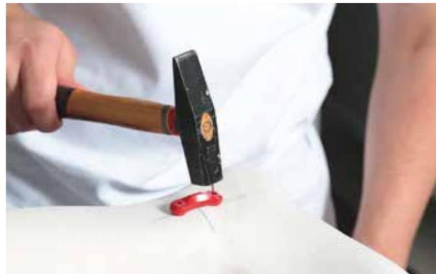
陽性モデルの印に合わせてダミーを設置します。釘を使用ししっかりと取り付けてください。
