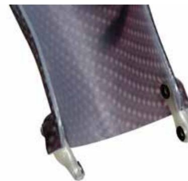
継手を取り付けます。トルクスレンチを使用し 0.5Nm で締めます。その際、カウンターサポートとして、内側のプッシュにもトルクスレンチを使用することができます。ネジが長すぎて内側にはみ出てくる場合は、ネジを削って短く、ユーザーが怪我しないように配慮します。
