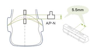
下腿部のダミーを抜き、選択したスナップストップを挿入する。
