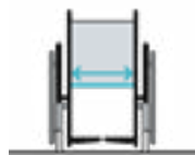
SB= cm Largeur d'assise bord extérieur du tube du cadre – bord extérieur du tube du cadre
