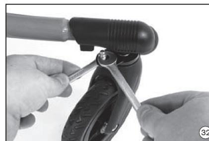
必要ならば直進の動きを再調整することもできます。前輪上にあるボルトがスリット内を動くようになるまで、ボルトを緩めます。ロックを掛けて、前輪を進行方向にセットします。10mmのレンチを使用してボルトを軽く締めてください。ロックカバーを解除して、前輪を外側に回して、2本のレンチを使用して（写真 32）ボルトをしっかり締めてください。
