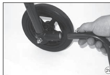
回転しないようにストッパーで固定されることを確認してください。転倒防止装置を使用しない時は上向きに（写真 30 の A）設定してください。
