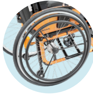
MG83 Einhandantrieb mit Doppelgreifring
