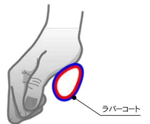
カーブのラバーコート仕様。広い接触面積とグリップの高い表面で、筋力に制限のある方でもハンドリムにしっかりと力を伝えられます。その結果、平地でも登り坂でも、筋力を効率的に使い、関節に過度な負担をかけずに車いすを操作することができます。
