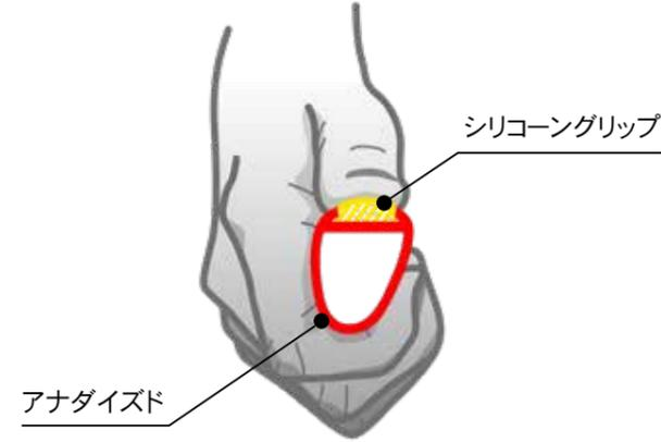
革新的な逆三角形の断面形状が自然に手にフィットし、車いすの操作性を高めます。平面になったリムの外周が手首を安定させ、一般的な円形断面のハンドリムと比べて筋肉が疲れにくく、痙攣や手根管症候群等による痛みを軽減し、リラックスして車いすを操作することができます。
