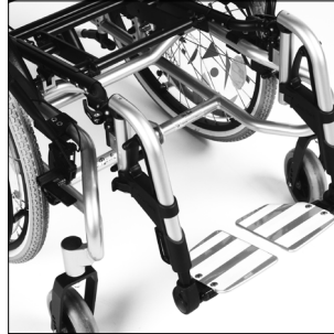
MB 18 Fussraste geteilt, winkelverstellbar, hochschwenkbar über Rastengelenk
