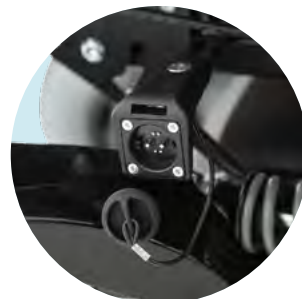
EU043 Prise de charge magnétique externe
