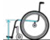
vSH= cm Hauteur d'assise avant Sol – Bord supérieur de la toile d'assise
