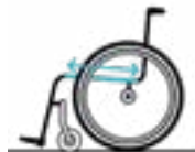
ST= cm Profondeur d'assise Bord avant de la toile d'assise – Tube de dossier
