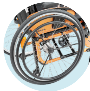
MG83 Einhandantrieb mit Doppelgreifring
