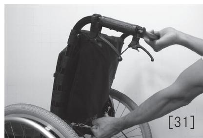
①バックサポート背面の下側にあるワイヤーを引っ張ると、バックサポートの角度を調整することができます。
