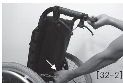
※バックサポート角度は最大120°になります。後方転倒を防ぐ為、角度調整時は必ず転倒防止装置を作動させてください。
