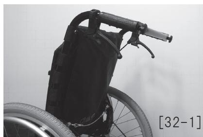
②希望の角度に調整したら、左右のロックが確実に固定されていることを確認した後、ワイヤーから手を離してください。
