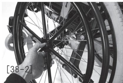
左右のホイールを連動させるためには車いす本体、シートの下部分に車軸連動バーを取り付ける必要があります。
