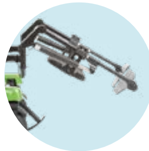
EB004 Beinstütze elektrisch hochschwenkbar, zusammen steuerbar
