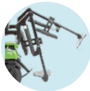
EB003 Beinstütze elektrisch hochschwenkbar, separat steuerbar
