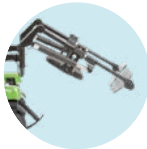
EB004 Beinstütze elektrisch hochschwenkbar, zusammen steuerbar
