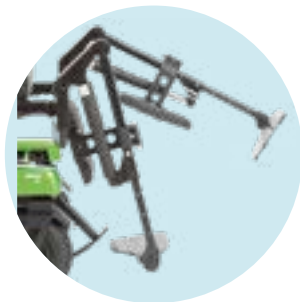
EB003 Beinstütze elektrisch hochwenkbar, separat steuerbar
