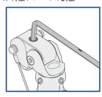
膝を屈曲した裏側に調整ネジがあります。 ネジの締め込みによって荷重ブレーキの調整ができます。
