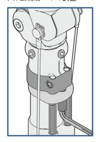
伸展補助バネの間にある調整ネジを回すことによってバネの強さが変わります。
